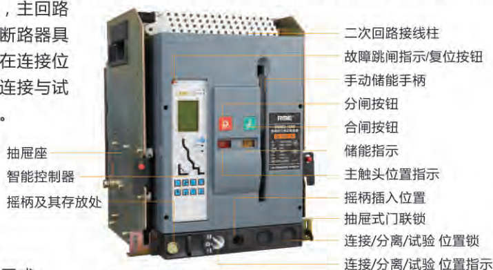
图1、断路器的结构示意图
